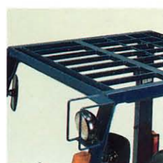
雨水対策も万全の雨とい 付大型ヘッドガード
