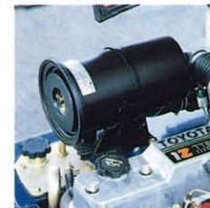
パキューターバルブの追加でサービス性の向上した大型サイクロンエアフィルター
