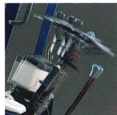
使う人に合わせて調整できるティルト&テレスコピックステアリング
