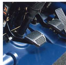
踏み込み時の踏力を軽減するターンオーバー型クラッチペダル (1トシ4Y-1DZのドライクラッチ車に採用)
