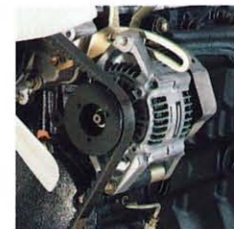
電圧を一定にコントロールするICレギュレーター付オルタネーター
