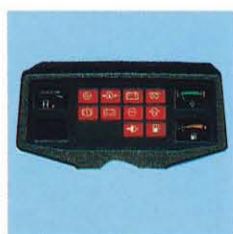
ひと目で確認できる集中 一体式コンビネーション メーター&OKモニター (オプション)
