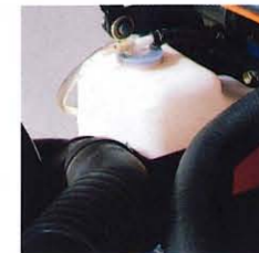
液量点検や補水が簡単容易なラジエーターリザーブタンク
