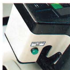
走行・荷役の最高速度を 規制できる走行・荷役ス ピードコントローラー (5K・4Y搭載車にオプション設定)
