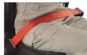
オレンジシートベルト 車両外からシートベルトの装着状態が確認しやすくなるため、管理者による作業観察を通じて、シートベルト装着を促すことが可能です。
