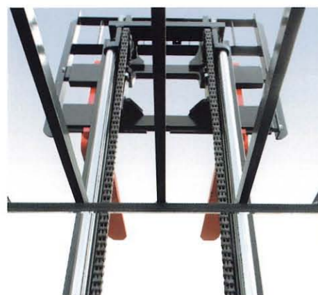
上方視野 先端部を斜め配置した格子型ヘッドガードの採用により、広い上方視野を確保しました。
