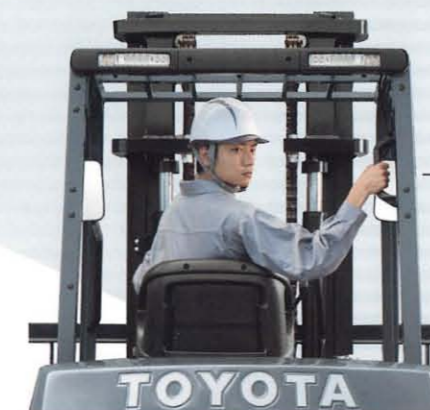
ホーン付リアピラーアシストグリップ 後進時も体がしっかり保持でき、そのままの姿勢でホーン操作も可能。安心走行に貢献します。
