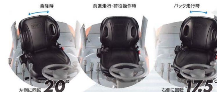
サスペンション付ORS回転シート OPT 右側に17.5°回転するため、バック走行時の姿勢がラクに保てます。また、左側にも20°回転。無理のない降車姿勢をとることができます。
