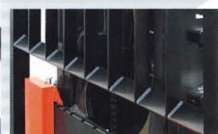
フォーク先端視野 バックレストのロアステーの斜め配置などにより、すっきり見やすいフォーク先端視野を確保しました。
