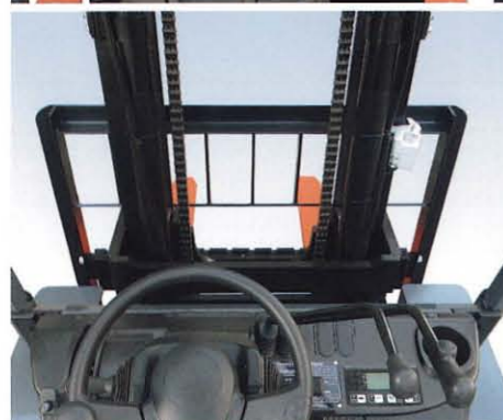
フォーク先端視野 バックレストのロアステーの斜め配置などにより、すっきり見やすいフォーク先端視野を確保しました。
