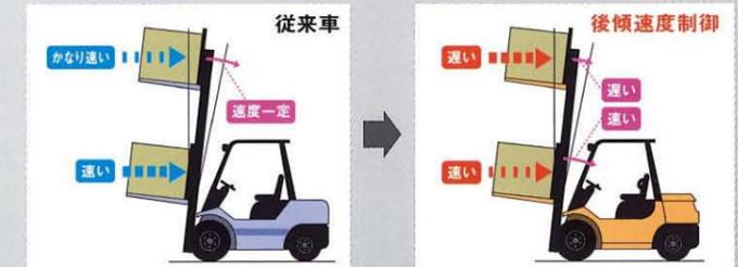
フォークの高低差による後傾速度の変化を改善し、高揚高では遅く、低揚高では速く、後傾速度を自動制御して荷崩れや荷物の破損を防止。
