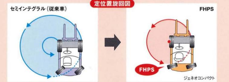
これまで一般的だったステアリング機構では、据え切り時のタイヤ切れ角に限度があり、旋回半径も大きめ。新採用のFHPSは後輪据え切り率100%で定位置旋回もOKです。※ Full Hydraulic Power Steering
