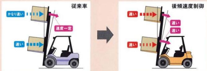
高揚高ではゆっくりと、低揚高では素早く自動的に速度をコントロールし、荷崩れによる荷物の破損やオペレーターへの衝撃も低減しました。
