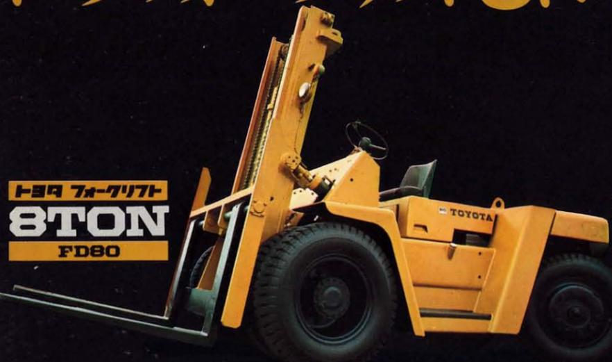
大型・大量輸送時代を迎え、ユニットロードは増々大型化・重量化しています。トヨタはこのユニットロードの大型化・重量化に対応し、国産で初めての8トン積フォークリフトを開発。
