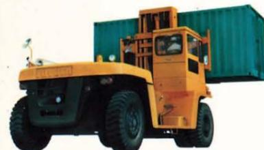
■人間工学に基づいた設計が細部にわたりゆき届いています。たとえば運転席。オペレーターの体格に応じて①前後調節・20mmピッチで5段階。②背角調節・2段階。③体重調節・オペレーターの体重(60kg~120kg)に応じてスプリングの調整。常に最適な姿勢での運転を可能にしました。
