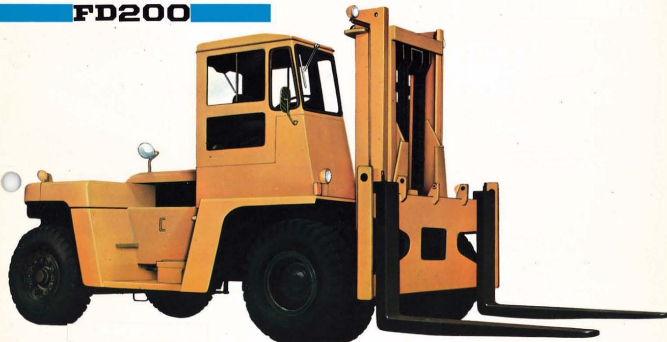
コンテナ荷役・鋼材荷役を主力とし、その他大型機械、外材等の大型荷役用として新たに開発された超大型フォークリフト——トヨタフォークリフト・20トン。エンジンは建設機械、大型トラック等で多大な実績のある日野DK10A型(ディーゼル)を特にフォークリフト専用に研究し改良しました。大出力大トルクで十分の余裕があります。また安全性・作業性・操作性・保守等も十分研究されています。数々の特徴を備えた、大型荷役作業をリードする超大型リフトです。
