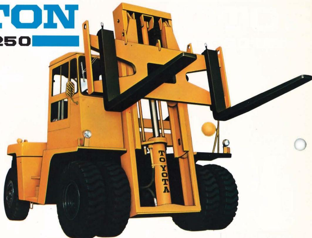
鉄鋼業・海上コンテナ等の大型荷役・大量輸送時代の要求に答えて、トヨタでは超大型フォークリフト——トヨタフォークリフト25トンを新たに開発いたしました。強力ディーゼルエンジンとして定評のある日野DK10A型を搭載し、あらゆる荷役作業に十分な余力を残す、強力設計です。また多くのパワー装備がなされているので、極めて軽力で自在に操作ができます。安全性・保守にも十分な配慮がなされています。
