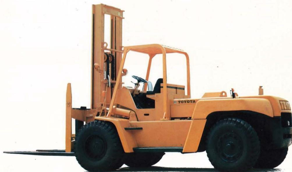
大型コンテナ荷役作業に、好評を博している、FD150を、時代の要求に答えて、海上コンテナ荷役専用開発した、トヨタフォークリフトFDA150。荷重中心を、一気に1,250mmまで延長して、大型海上コンテナ荷役作業に、十分対応できるようにしました。抜群の安定性と、余裕ある能力を有した、大型輸送時代の決定版フォークリフトです。
