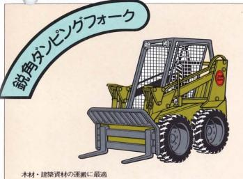
■バックレストがフォークに対して前傾していますから、木材や建築資 材などの長尺物を運搬する場合、走行中に荷がこぼれ落ちず安全です。
