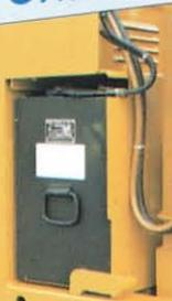
手軽で、しかも確実にロックする遮断機式外部ロック方式を採用しています。また、バッテリー室前面にカバーを設け、万一の落下物からバッテリーを完全に保護します。
