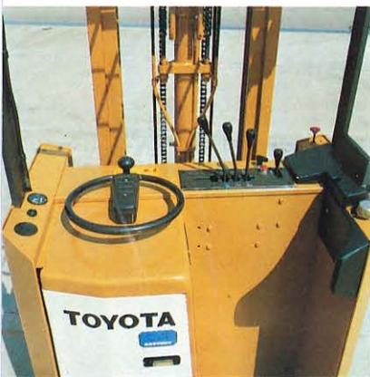
頑丈なヘッドガードの標準装備は勿論、使い易いハンドル・レバー・ペダルなどの機能的なレイアウト、さらに大型アームレスト・背もたれのクッションの採用……など、操作性と安全性を一段と追求した人間工学設計が細部にまでいかされた運転席回りです。
