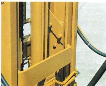
マストのガタや振れを防止するため、マストのローラ及び、リフトブラケットのミドルローラを外部調整式にし、さらにチェーンホイールサポートに動滑りブッシュを組込みました。
