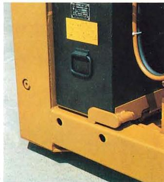
遮断機式外部ロック方式を採用。手軽に、しかも確実にロックします。また、バッテリーは左右どちらにも引きだせ、バッテリーの点検の際非常に便利です。
