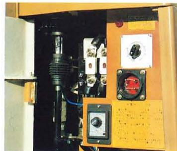
自動準定電圧方式のチャージャーに自己復帰型タイマーを装備しました。従来のタイマーや、HVR、マグネットスイッチ等が作動不良となり電源回路が遮断されなくなった時、このタイマーの働きにより電源が切れ、過充電を防ぎます。
