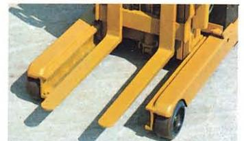
ロードタイヤ幅は120mm。リーチレックの幅も大きく、荷役・走行時ともに機台の安定性を高めています。
