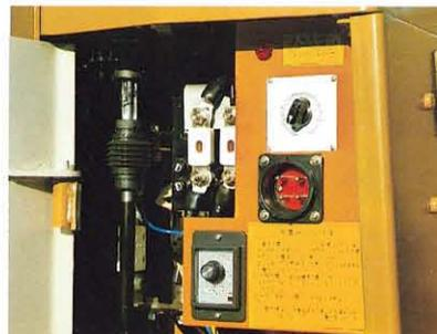
自動準定電圧方式のチャージャーに自己復帰型タイマーを装備しました。従来のタイマーや、HVR、マグネットスイッチ等が作動不良となり電源回路が遮断されなくなった時、このタイマーの働きにより電源が切れ、過充電を防ぎます。
