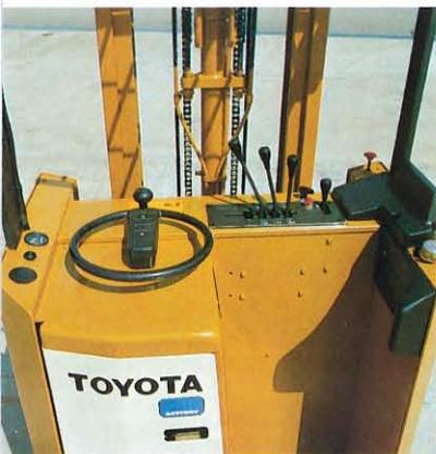
頑丈なヘッドガードの標準装備は勿論、使い易いハンドル・レバー・ペダルなどの機能的なレイアウト、さらに大型アームレスト・背もたれのクッションの採用……など、操作性と安全性を一段と追求した人間工学設計が細部にまでいかされた運転席回りです。
