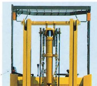
マスト内幅を可能な限りワイドに設計。前方視野が広く、荷役・走行時の安全作業を確保します。
