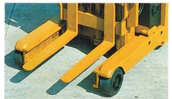
ロードタイヤ幅は120mm、リーチレグの幅も大きく、荷役・走行時ともに機台の安定性を高めています。
