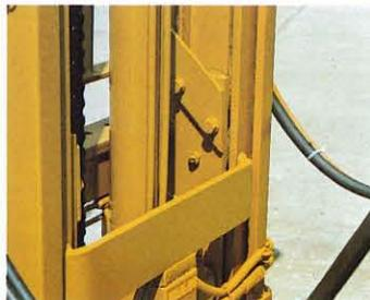
マストのガタや振れを防止するため、マストのローラ及び、リフトブラケットのミドルローラを外部調整式にし、さらにチェーンホイールサポートに樹脂ブッシュを組み込みました。
