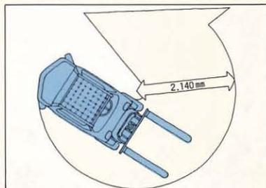
トヨタ自慢のコンパクトな設計とクッションタイヤが生む小回り性能の良さが見事にマッチしたトヨタフォークリフト3トン積・クッションタイヤ付。
