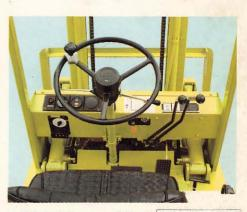
■強固な守りのヘッドガード (小特仕様にも装備) 広い面積のヘッドガード。どんな落下物もガ ッチリ受け止める4脚式。オペレーターは安
