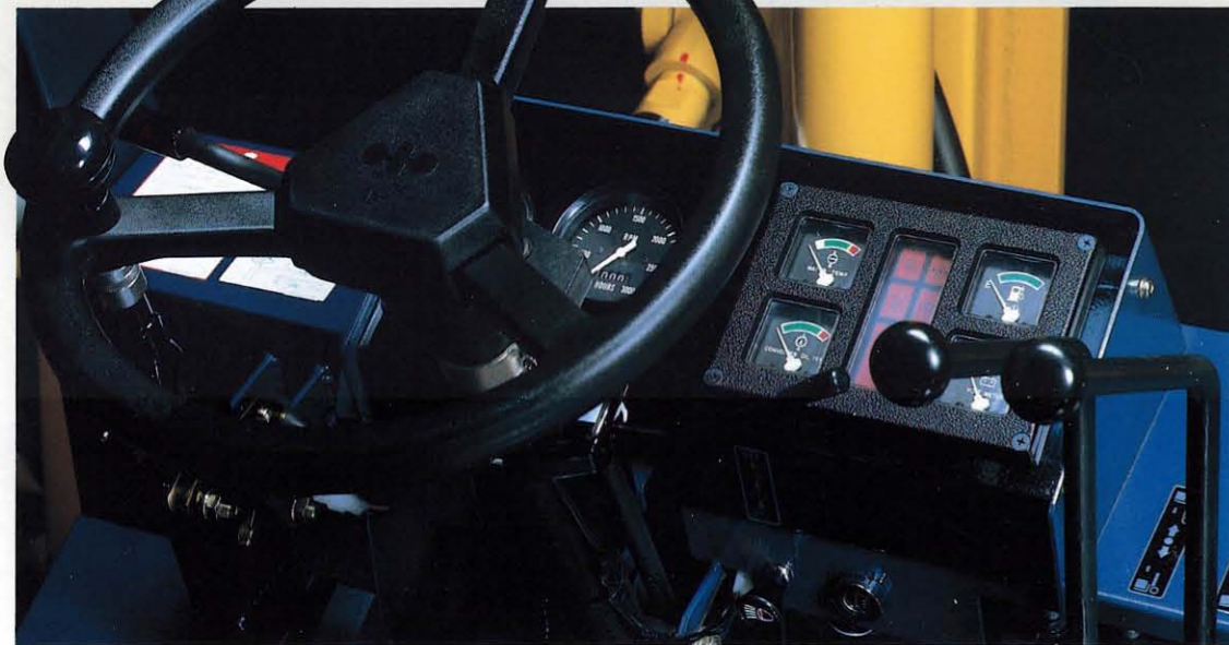
●フルフローティングキャブと合わせ、サスペンションリクライニングシート、ティルトハンドル、小径ハンドル、セフティチェックなど、トップクラスの居住性・操作性を誇る運転席廻り。
