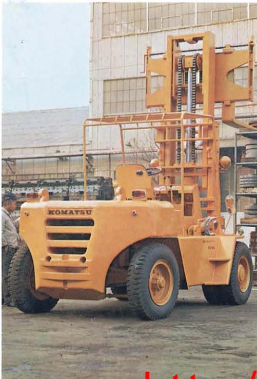
■荷揚速度は全負荷時でこのクラス最高の310mm/s。マスト傾斜角も前6°、後12°と大きく、F26km/h、R25km/hの速い走行速度と相まって作業能率は抜群。
