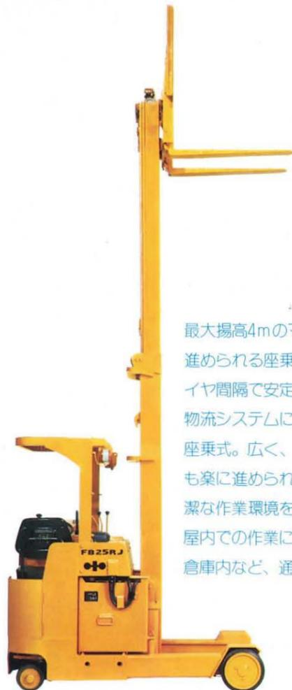
最大揚高4mのマストを標準装備した、長時間の作業も楽に進められる座乗式リーチフォーク。低い重心位置、広いタイヤ間隔で安定性も高く、高層化、大型化するこれからの物流システムに適した2t、2.5t積みです。しかも、運転席は座乗式。広く、ゆったりとしており、操作性もよく、作業も楽に進められます。動力はバッテリー式。さわやかに清潔な作業環境を保ち、汚れを嫌う商品の運搬や閉めきった屋内での作業にも最適です。もちろん、抜群の機敏性で、倉庫内など、通路の狭い所でも大活躍をします。
