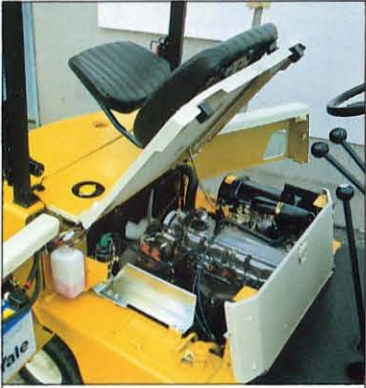
ワンタッチ式フルオープンエンジンフードを採用。エンジン、トランスミッションまわりの保守・点検作業が簡単に行えます。
