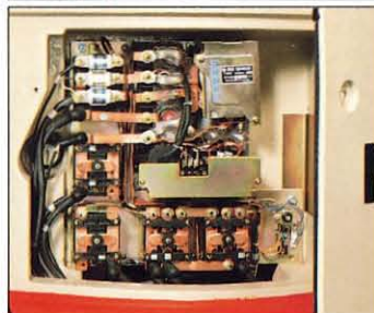
バッテリー車の頭脳 1体集中コントローラシステム
