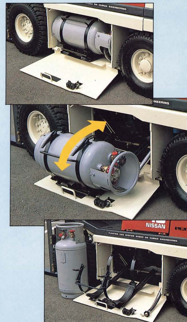
▲コンパクトフォークLPG1.5トン可動式バックレスト付車
