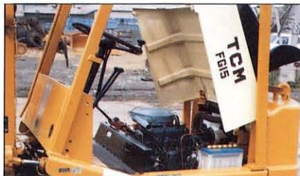
フードは後ヒンジ前開閉式で、フロアボードをはずすとエンジンルームはもとより、トランスミッション、クラッチまわりも一目でみわたせます。また、フードは落下防止装置を備えていますから、安心して点検できます。
