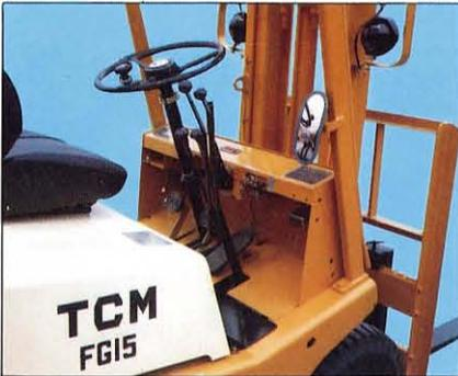
右側に配置したレバー類は操作しやすく、バルブは右下に配置し、フロアは広くすっきり。座席は、最適な運転姿勢が得られる、フルクライニングシートですから、長時間作業でも疲れ知らずです。
