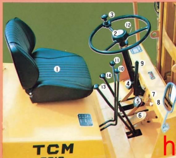
軽快なフィンガータッチのレバー類は運転席のすぐ右側に、バルブはシート右下に適正配置してありますので、フロアは広くすっきり。長時間の運転でも疲れが少ないオペレータ主義に徹したらくらく設計です。
