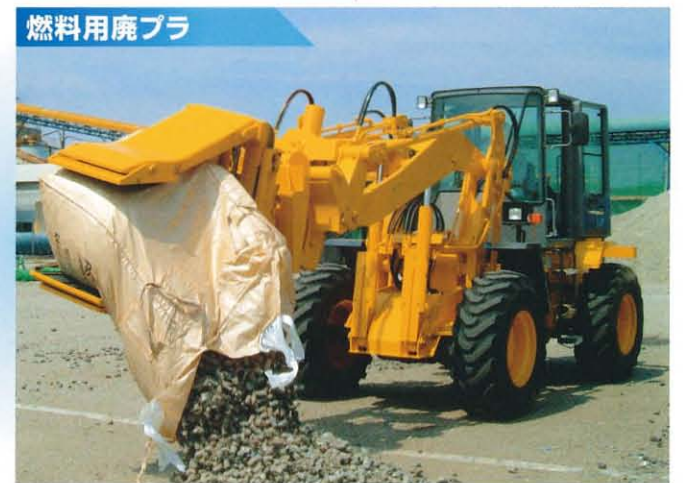
回転式ロードグラブでフレコンバックの移動、開放作業。
