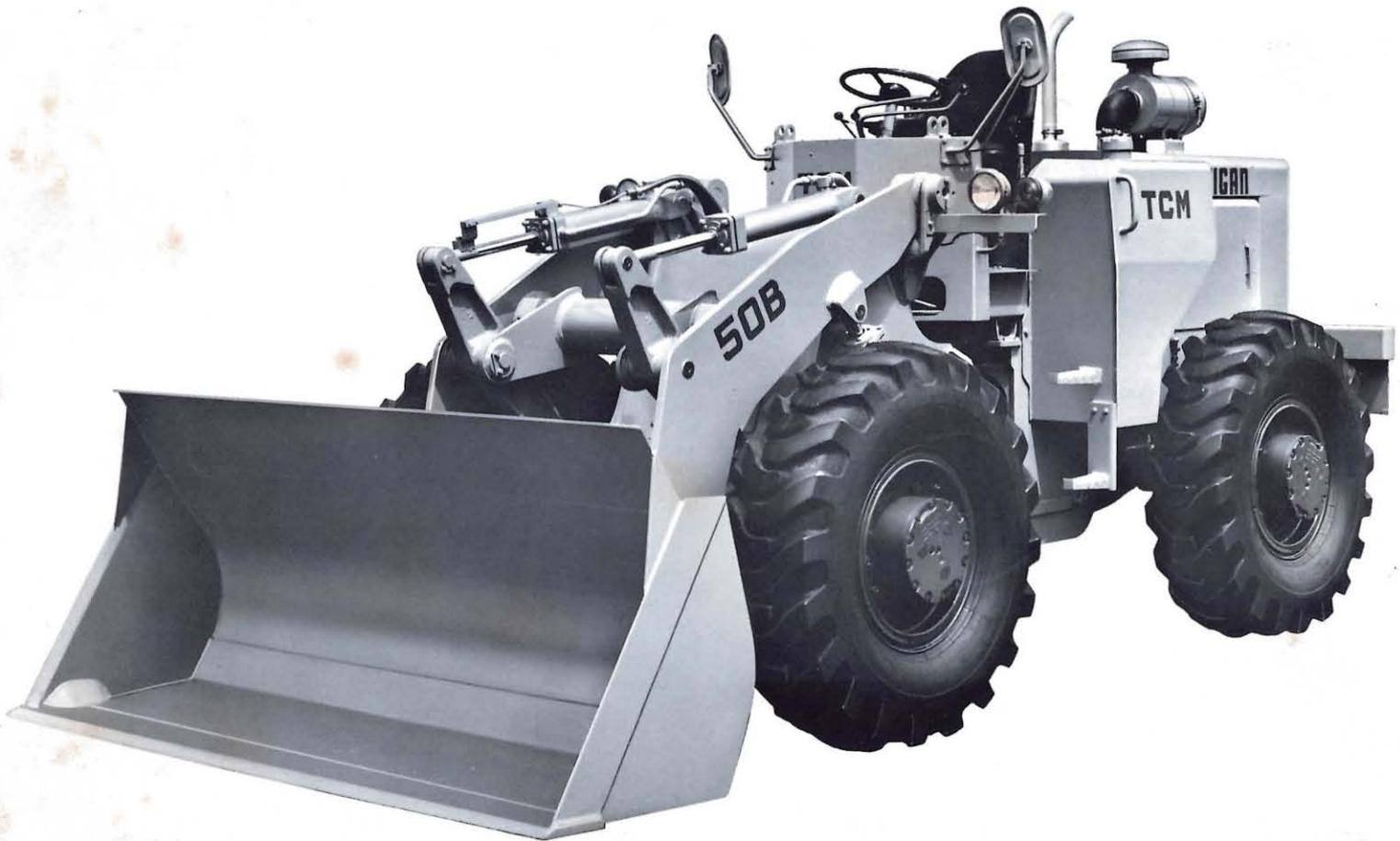
■強力で効率よい、いすゞ6BB1ディーゼルエンジンを搭載。馬力当り重量は87kg/psと小さく、高能率の作業ができます。
