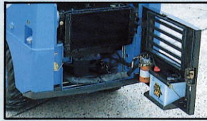
▲ワンタッチ開閉テールゲートボンネット、バッテリーHSTフィルタのテールゲートマウント
