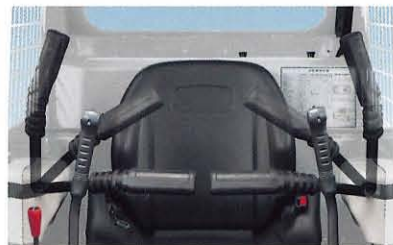
セーフティバーと荷役ペダル安全ロック が連動する安全機構
