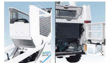
点検・整備を容易にするティップアップ 方式のヘッドガードとワンタッチ開閉式 テールゲート・ボンネット
