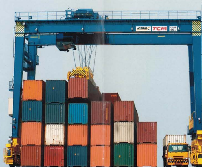
ハイブリッド式トランスファークレーン(タイヤ式) CT4H
