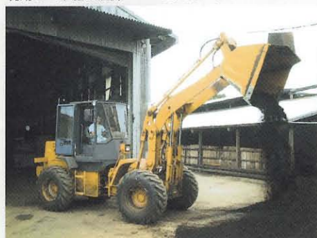
3.2mオーバーのダンピングクリアランスを利用して堆肥の攪拌——L13リーチ
