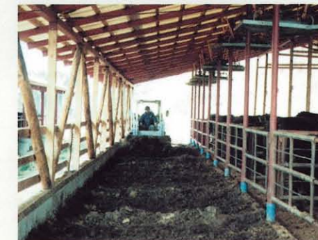
パワフルでなめらかなHST、4駆の威力でずみずみまで除糞——SSL608
