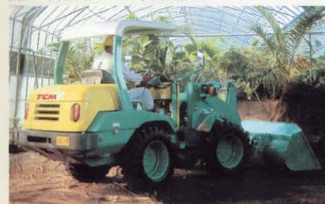
間口が低く狭いビニールハウスへの出入も自由自在——低床式LL3
