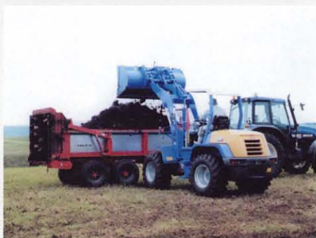
堆肥散布車へ堆肥の積込作業——メッキホイール付L9-2
