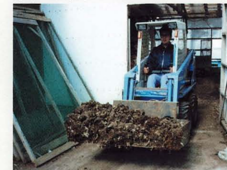
鶏糞の除糞はウイングバケットで、群を抜く処理能力——SSL603
