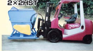
畜舎内でも真横に走るACROBAで作業性アップ——給餌機付 FA20D、
