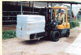
ラッピングした飼料をクランプして運搬——タナフォーク付 FG25
