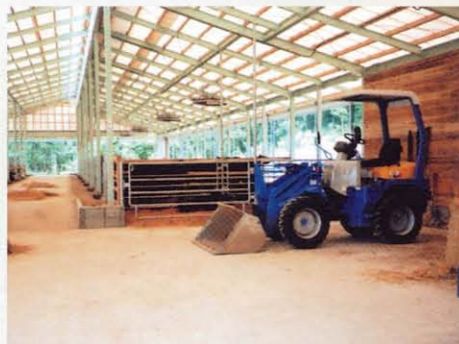
敷料の運搬に、小回りの効いた作業が可能——メッキバケット、メッキホイール付L3-2
