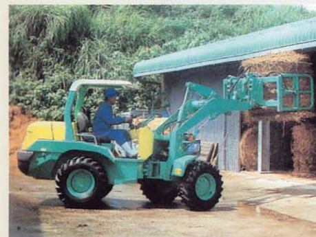
屋根の低い家屋へもスムーズに出入可能——低床式LL4(ロールグラブ付)
