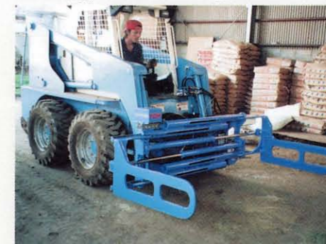
ラッピングした牧草ペールを効率よくはさんで運搬——ロードグラブ付SSL610
