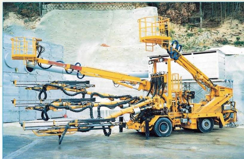
①トンネル掘削機のアトラスドリルジャンボは、ドリルの回転とハンマー打ちにより、硬い岩盤も掘削できます。最大機種は3ブーム2バケットH195から、2ブーム1バケットの中型322-1Bまで4機種。
