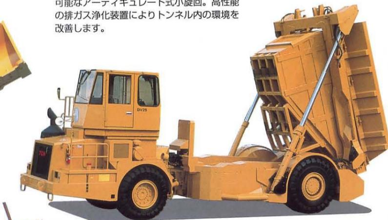
③ずり運搬車ベッセルダンプは、スムーズな放出作業が行なえるダンプ方式。路盤のわだち防止に低接地圧タイヤを採用。トンネル内のUターンが可能なアーティキュレート式小旋回。高性能の排ガス浄化装置によりトンネル内の環境を改善します。
