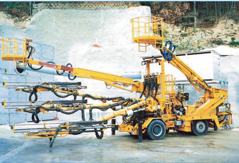
①トンネル掘削機のアトラスドリルジャンボは、ドリルの回転とハンマー打ちにより、硬い岩盤も掘削できます。最大機種は3ブーム2バスケットH195から、2ブーム1バスケットの中型322-1Bまで4機種。
