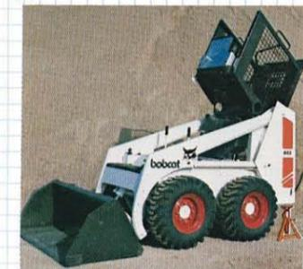
**セルフレベルリングバルブの採用でバケット水平を維持**
