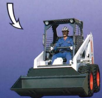
シートバーは、ブーム、バケットペダルと連動したロック機構を持っているため、シートバーをセットしないとブームペダルが作動しません。
