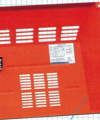
開閉が容易で堅固なスチール製のテールゲートを開けると、エンジンを中心にエンジンオイル、冷却水、エアクリーナ、バッテリー、エンジンオイルフィルタなどの点検はいたって容易です。
