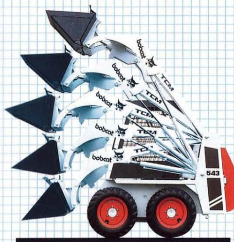
セルフレベルングバルブ(油圧式バケット補正)の採用によって、ブーム上昇時には自動的にバケットが補正され水平を保ちます。またブーム、バケットを同時に操作できるので、サイクルタイムをグッと短縮。平行リンクがないので運転席からの視界が良く、バケットの先端が見えるので作業が楽です。
