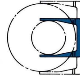
扱物径の範囲が極めて広く、縦置ロールの荷役作業に最適。
