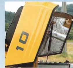
ボンネットとフレームの接合部、ラジエータカバーとカウンタウェイトのすき間はシールゴムで密封。さらにボンネット内側にはグラスウールの吸音材、フロアボード下側には遮音性に優れた吸音材、上側には大形のフロアマットをダブルで取付、エンジン音を外に漏らさない配慮が施されています。
