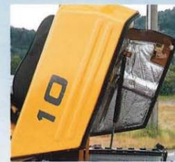
ボンネットとフレームの接合部、ラジエータカバーとカウンタウエイトのすき間はシールゴムで密封。さらにボンネット内側にはグラスウールの吸音材、フロアボード下側には遮音性に優れた吸音材、上側には大形のフロアマットをダブルで取り付け、エンジン音を外に漏らさない配慮が施されています。
