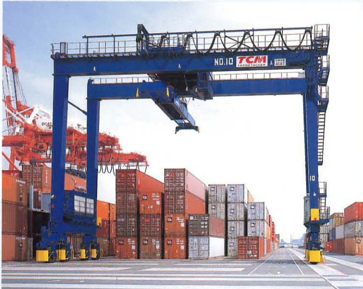
トランスファークレーン
