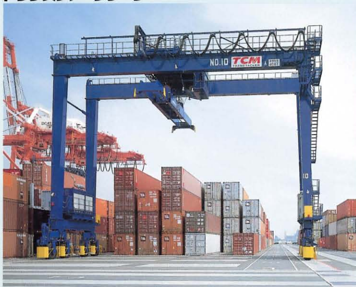
トランスファークレーン
