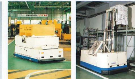
ニューキャリコン 0.3~1t積み 無人サイドフォークリフト 0.5~5t積み
