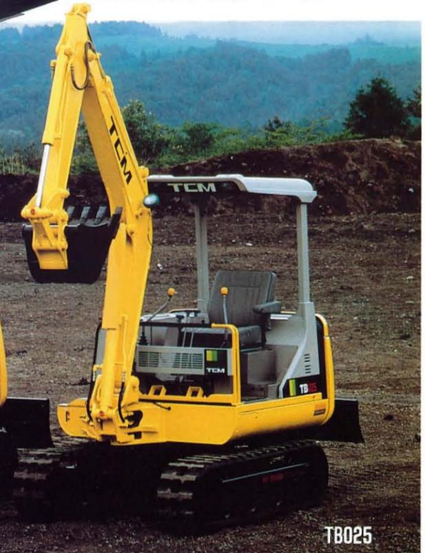
TCMミニバックホーNEW TBシリーズは、レモンイエローとライトグレーが織りなすカラーリングは、斬新そのもの。人にやさしいまるいフォルムは、使う人の感性を規準に理想的なカタチに創り上げました。主な特長は、クラス最大のエンジン出力・走行速度・掘削深さ。ニュータイプコントロールバルブシステムにより、思うがままの操作フィーリングを実現。走行、アタッチメント同時操作システムにより、走行中のアタッチメント操作が可能。本体後部に作業警告灯を装備し旋回時の事故などを防止。フロアアップ機構の採用でサービス&点検が一層容易。チェック機能満載のアラームモニターシステムなど高次元の性能を、あます所なく搭載しています。
