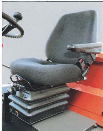
作業中の振動や衝撃を吸収するロングストロークサスペンションシートを用意しています。
