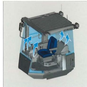
フロント3カ所、リヤ2カ所のデフロスタを標準で装備。雨天時や寒冷時に発生しやすいガラスの曇りを除去し、視界を良好に保ちます。
