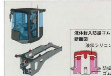
キャブ全体を液体封入防振ゴムでマウント。キャブ重心とマウントの配置を最適化し、共振を抑え、キャブの低振動化を実現。オペレータの疲労軽減に貢献します。
