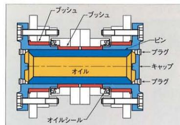
フローティングピンはオイル封入式で、給油間隔が2,000時間と長くメンテナンスの手間が省けます。
