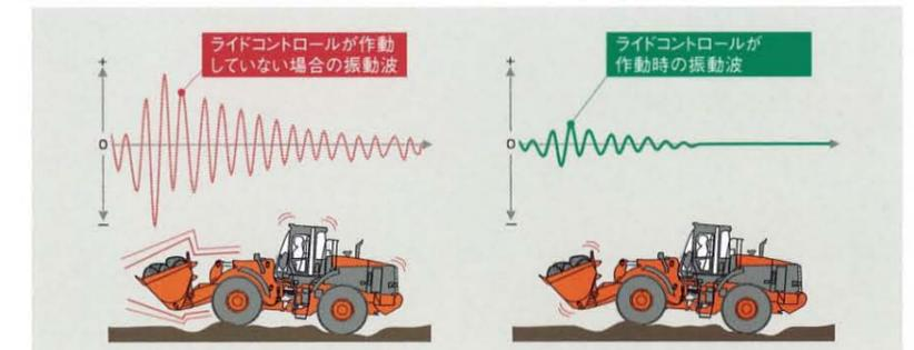
悪路や雪道などを走行するときに発生する車両の縦揺れ(ピッチング)や飛び跳ね(バウンス)を打ち消すようにフロントを自動制御します。振動や衝撃が抑えられるため、乗り心地の良さと荷こぼれの低減に大きく貢献します。
