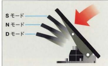
平地でのスピーディーな作業、傾斜地での確実な作業など、あらゆる作業環境に柔軟に対応できるよう、クラッチカットオフのタイミングを3パターン設定しました。作業内容に応じてポジションを切り替えることで、作業効率のアップとオペレータの疲労軽減が図れます。
