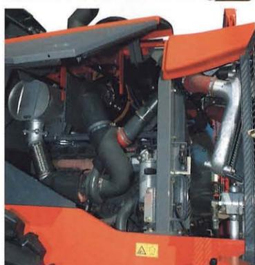
地上から点検・交換しやすい位置に、ウォータセパレーター体型の燃料フィルタやエンジンオイルフィルタを配置しています。
