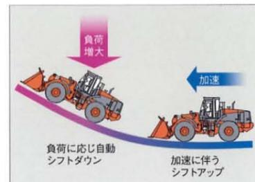
従来機では、オートマチックの変速タイミングを車速により決定していました。ZWシリーズでは、車速に加え、各種センサから車両の負荷を検知。用意した変速プログラムの中から最適な変速タイミングを自動的に選択し、スムーズな走りを実現します。
