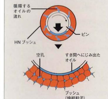
\* HNブッシュとは日立独自の開発による、浸炭焼入れ高硬度の焼結金属に高粘度特殊オイルを真空含浸させた、長寿命・耐高荷重ブッシュです。稼働中はブッシュの空孔に蓄えられたオイルが、防錆処理したピンのとのすき間に染みでて自己潤滑をします。
