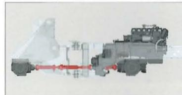
プロペラシャフトのフラット配置を実現。ジョイント部の抵抗を低減したことにより、耐久性が向上します。
