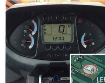
インジケータや警告表示、液晶モニタのバックライトなどに、LED(発光ダイオード)を採用。従来の電球や蛍光管と比べて非常に長寿命で、球切れなどのトラブルが起こりにくいため、表示系の信頼性が大きく向上しています。
