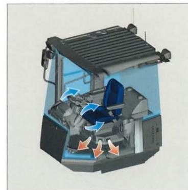
温度設定によって、風量や吹き出し口、温度を自動的にコントロール。
