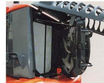
温度感応型油圧駆動の冷却ファンは、清掃時などに逆回転させることが可能。これにより、手軽な操作でラジエータに詰まったごみなどを取り除くことが可能です。また、油圧駆動ファン自体も、ヒンジによって開閉が可能ですので、エアブローによる清掃作業も行えます。
