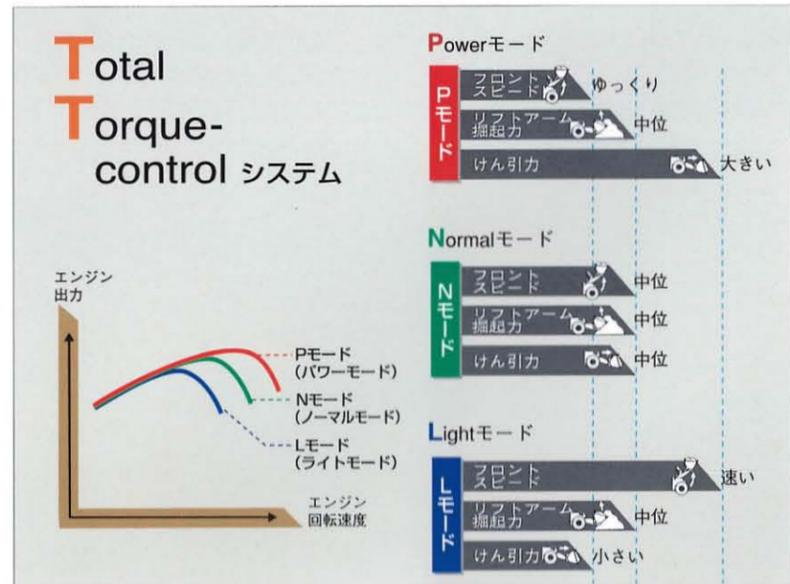
作業内容やオペレータの操作の好みに応じて選択できる3つの作業モードを用意しています。各モードは、独自に開発した業界初のトルク制御により、エンジンとポンプの両トルクを協調して制御。3つの作業モードすべてで、突っ込み力とフロント全体のスピードをベストにマッチングさせます。この制御により、オペレータの操作の好みに柔軟に対応するだけでなく、扱い物によりモードを変更させることで、燃費あたりの作業量の増大も可能となりました。
