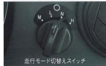
走行【Lモード】は、2速からスタートし、早めのタイミングでシフトチェンジを行います。平地での長距離移動に適したモードです。
