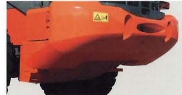
地面をこするほどの掻き上げ作業でも、大型のカウンタウエイトで燃料タンクを保護します。
