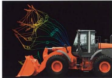
新パラレルタンデム回路の導入により、従来機ではできなかったリフトアームとバケットを同時に動かす複合動作が可能になりました。掘削や積込みといったフロント作業を効率良く、スムーズに行えます。
