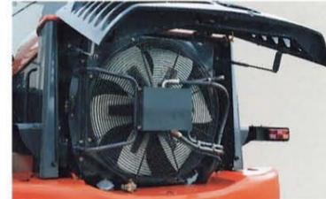
冷却水、作動油、トランスミッション/トルクコンバータのオイルを冷却するためのファンに、温度を感知して無段階に回転速度を制御する温度感応型油圧駆動ファンを採用。きめ細かな冷却が可能になることで、各コンポーネントや部品の長寿命化に貢献します。燃費の面でも有利です。また、エンジンと分離された独立駆動となっているため、メンテナンス性の向上にも寄与します。
