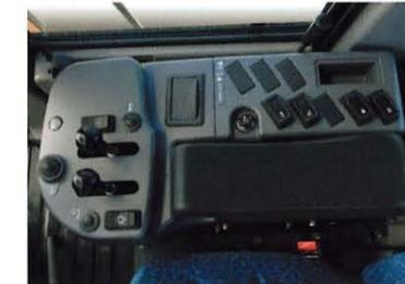
運転前の設定に使用するスイッチ類はシート右側のコンソールに、作業中・走行中に使用するスイッチ類は前コンソールに、それぞれ使用する場面に適した位置に配置しています。
