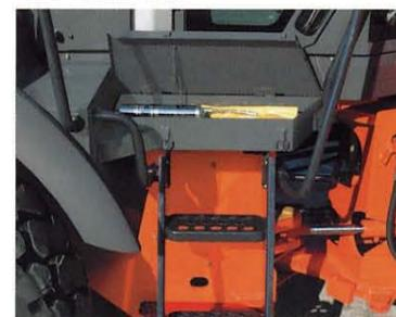
車体右側の昇降ステップの最上段に大型の工具箱を標準装備。グリースポンプや日常工具の収納に便利です。
