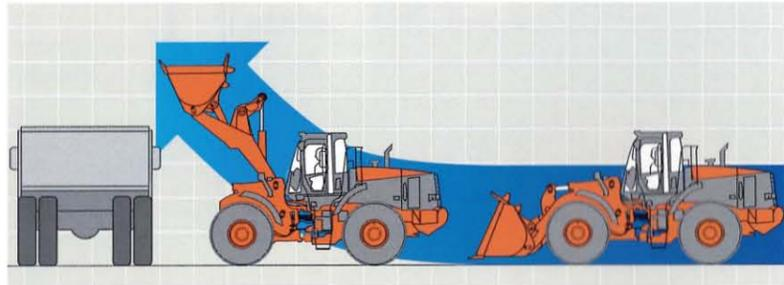
走行しながらリフトアームを上げていくライズランを約10%スピードアップ。積込み効率が向上するため、作業量の増大に貢献します。また、運転のしやすさもアップします。
