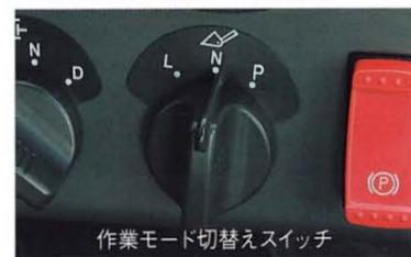
作業【Pモード】 重掘削作業
