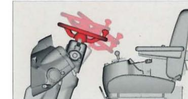
ステアリングホイールは、角度を調整するチルト機能と、オペレータとの間隔を調整できるテレスコピック機能を装備。オペレータの好みや体格差にも柔軟に対応します。
