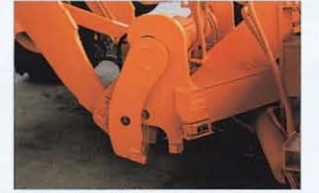
クイックカブラ (油圧式) 運転席からレバー操作で油圧シリンダを作動させ、アタッチメントの脱着ができます。
