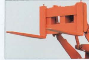
ランバフォーク 角材など製品材の積込み、運搬作業などに適しています。荷材に合わせ、フォーク間隔を手動で調整できます。
