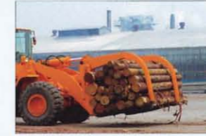
ロググラップル 小径短尺から大径長尺まで、原木の積込み、運搬が行える専用のアタッチメントです。
