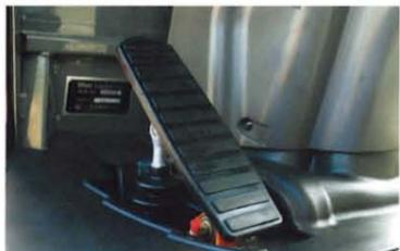
ブレーキ/インチングペダルはアクセル操作とは無関係に車速に相当する走行用油圧ポンプの吐出量を調整します。この結果、ブレーキ/インチングペダルだけで車速の調整が可能です。積み込みの際の位置合わせを容易に行えます。
