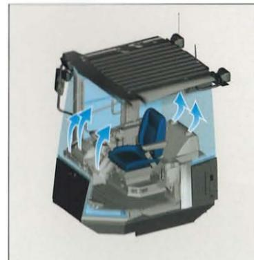
フロント3ヵ所、フロントサイド2ヵ所、リア2ヵ所のデフロスタを標準で装備。雨天時や寒冷時に発生しやすいガラスの曇りを除去し、視界を良好に保ちます。
