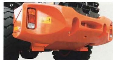
車体後部、後側部を接触・追突からまもる、大型カウンタウエイトを装備しています。
