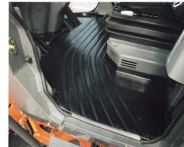
キャブドア周辺のデザインを変更し、段差のないフラットなフロアを実現。ほうきで掃くだけの手軽な作業で、キャブ内の掃除が可能です。
