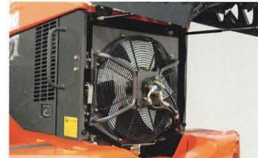
冷却水、作動油を冷却するためのファンに、温度を感知して無段階に回転速度を制御する温度感応型油圧駆動ファンを採用。きめ細かな冷却が可能になることで、各コンポーネントや部品の長寿命化に貢献します。燃費の面でも有利です。また、エンジンと分離された独立駆動となっているため、メンテナンス性の向上にも寄与します。
