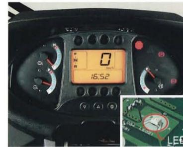
インジケータや警告表示、液晶モニタのバックライトなどに、LED（発光ダイオード）を採用。従来の電球や蛍光管と比べて長寿命で、球切れなどのトラブルが起こりにくい。そのため、表示系の信頼性が大きく向上しています。
