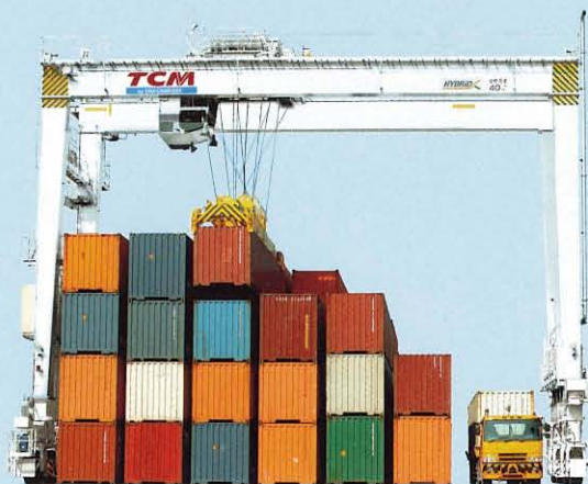
ハイブリッド式トランスファークレーン 海上コンテナ用 4~5段積み対応
