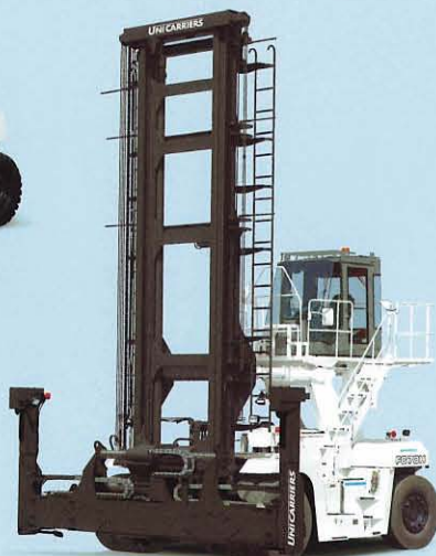
空コンテナ専用フォークリフト 海上コンテナ用 5段積み対応
