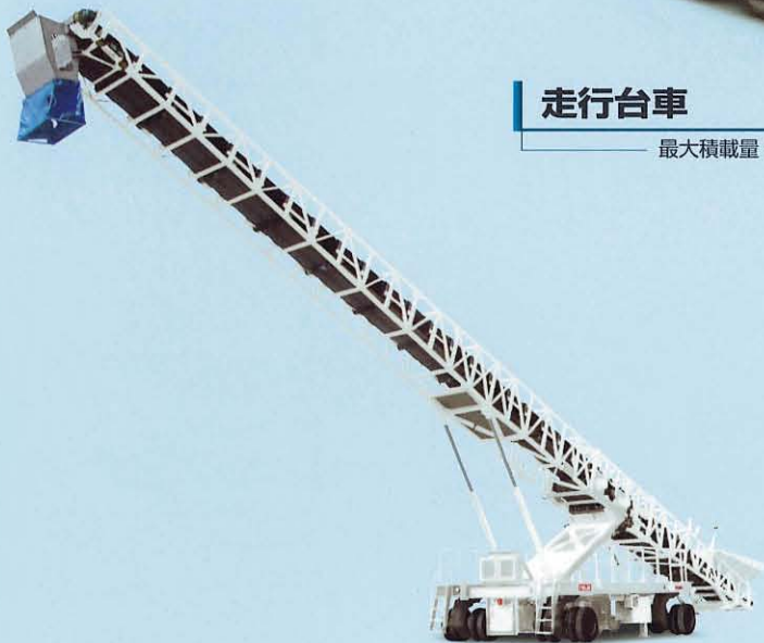
自走式ベルトコンベア 高積み用&船積み用
