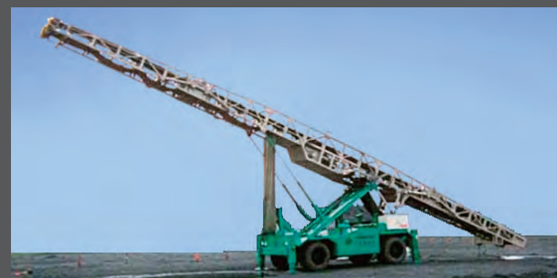
TBL3 搬送能力300t/h オプション:コンベヤ折畳み
