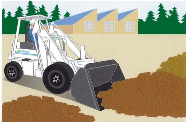
砂利、チップ材、肥料、飼料などの細かな運搬物を扱う場合でも、大きなバケットと操作のしやすさでスムーズな作業が可能です。
