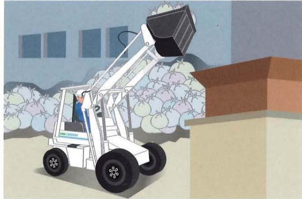
ゴミの掻き集めや集積はもちろん、大きなダンピングクリアランスによって高い位置にあるホッパーへの投入作業も容易です。
