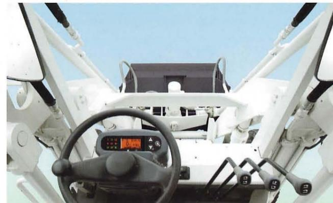
ストレスのない操作を可能にするレバー類の配置、視認性に優れた多機能液晶モニターメタパネルの採用など、荷役作業から走行時まで、安全性と快適性を追求したコックピットです。
