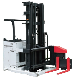
■ラックフォーク わずか1480mmの通路幅で高い機動性を発揮。
