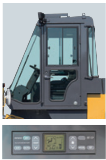
エアコン操作部
