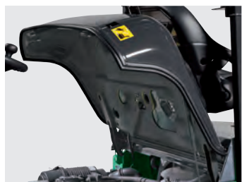
大型発泡充填遮音材をボンネット内側に装備
