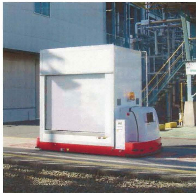
・様々な防水対策により屋外で力を発揮する「ムジンカー」(原外仕様)
