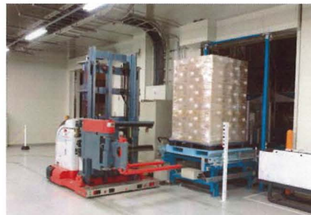
・自動倉庫入出庫装置までの搬送を自動化する「ラックフォークオート」
