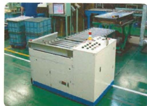
・生産ラインで工程間搬送(ローラーコンベヤ方式)
