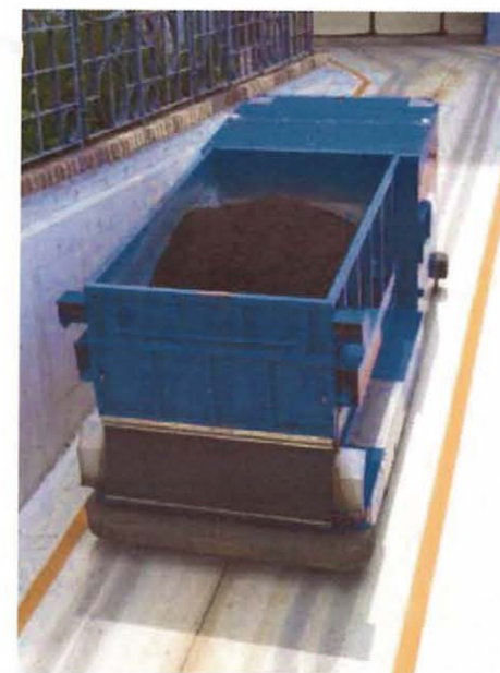
・勾配10度の坂道を登坂し産廃物を搬送する「ムジンカー」(高登坂仕様)
