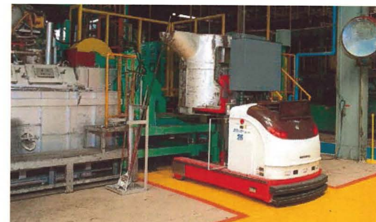
・24時間稼働で高温710℃の溶湯運搬に活躍する「ブラッターオート」
